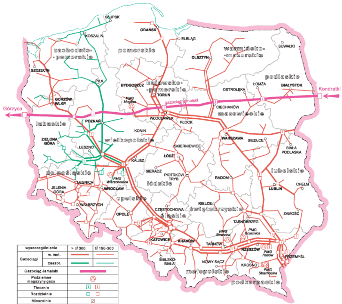
Rysunek 14. Układ przestrzenny polskiej sieci gazowniczej (źródło: www.geoland.pl )
