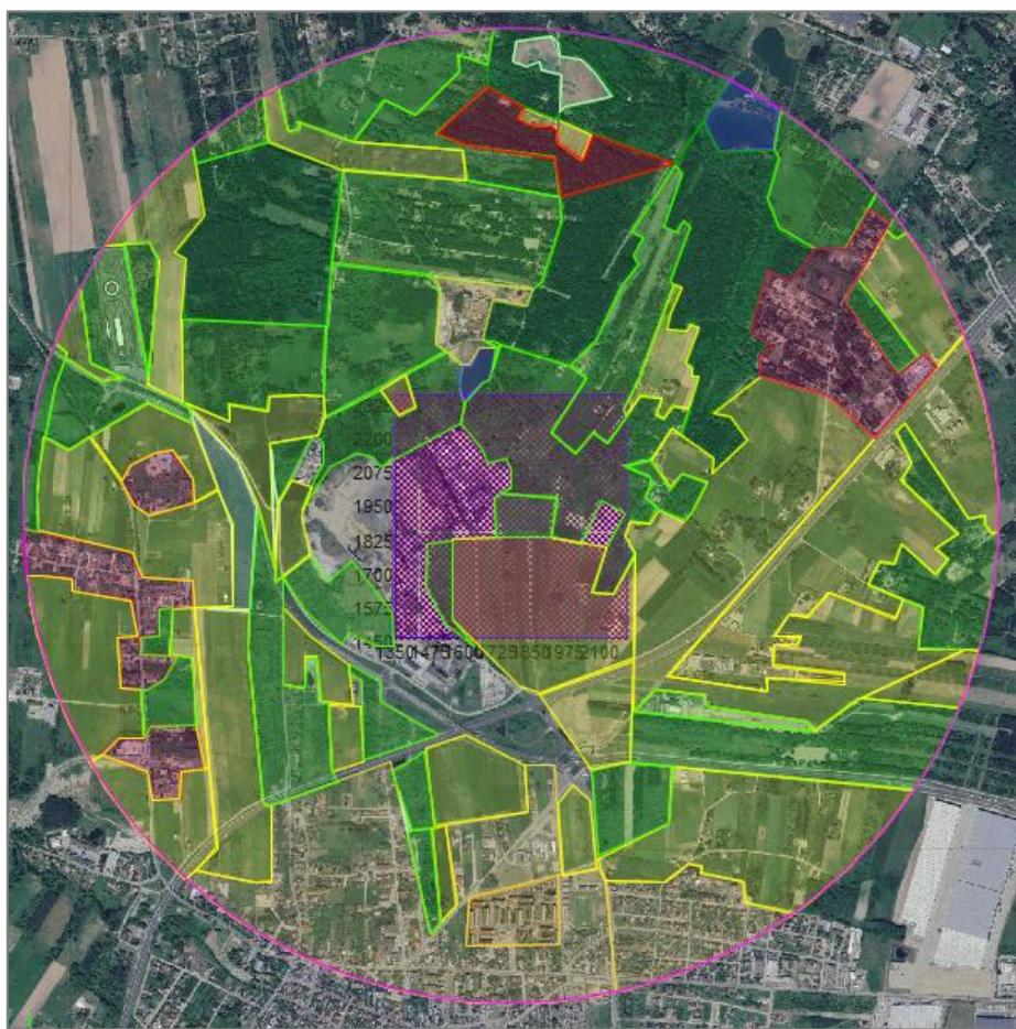
Rysunek nr 35 Mapa zasięgu 50*h najwyższego emitora z uwzględnieniem podziału aerodynamicznego terenu.
