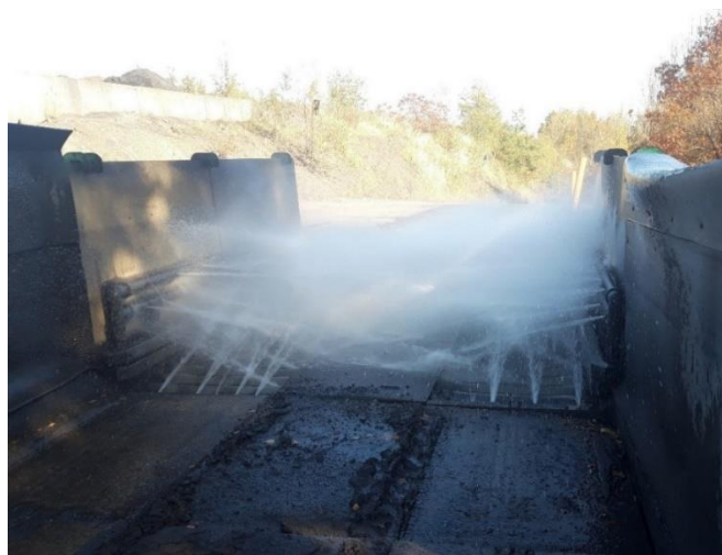
Fotografia 1 Myjnia kół samochodowych, pracująca w obiegu zamkniętym
